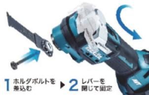
工具レスで簡単ブレード交換
