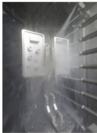
各モジュールはすべて幅600mmで、洗浄、エアブロー、真空乾燥といった機能別のモジュールを、自由に組み合わせることができる。
