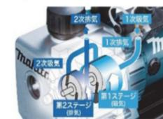
第1ステージの1次排気を第2ステージの吸気口に低い圧力で送り込み、高い真空度を得ることが可能。2段圧縮機構搭載で、大型機器の真空引きに十分な真空度を実現
