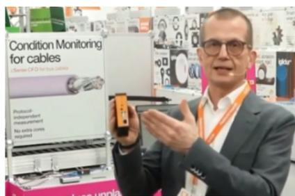
センサを1つのモジュールで一括管理する第2世代のi.Sense：moduleです。従来は4つのセンサに対し、4つのモジュールが必要でした。しかし、新モジュールは1台で管理でき、必要な機器数が減ります。センサのデータ記録に従来使用したSDカードを廃し、USBポートから情報を出力します。また、データや設定は、モジュール内ストレージに保存可能です。設定や値の変更、測定センサデータのダウンロードは、iPadからワイヤレスで可能です。リモートリセットにも対応しています。SNSで保守担当者の携帯に情報を送れます。また、小型のGPSが搭載されており、位置情報を取得し、これに応じた測定値補正を行います。これが状態監視の仕組みです」(リチャード・ハーベリング氏)。
