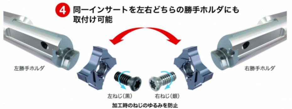
切れ刃から離れた位置でホルダのポケットに接しており、たとえ一つのコーナが欠損してもインサートクランプには影響せず、そのまま他のコーナを使用して加工を継続できる。
