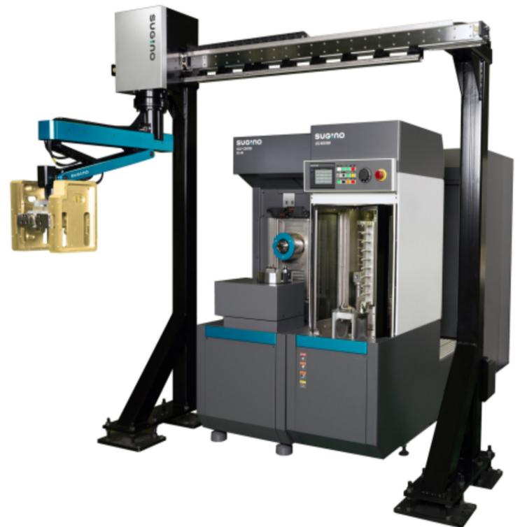
ット「CRb020H4」は、コラムロボットのメリットを継承しつつ、4軸で可搬質量20kgを可能にした水平タイプ。軽量なアームとリンク機構を組み合わせた独自構造により、高速動作を可能にする(特許出願済)。
