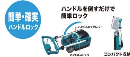
ルを倒すだけでロックが可能。ロック解除する際はロックレバーをつまんで解除できる。ワンタッチ操作で確実なハンドルロックとロック解除を可能にする。
