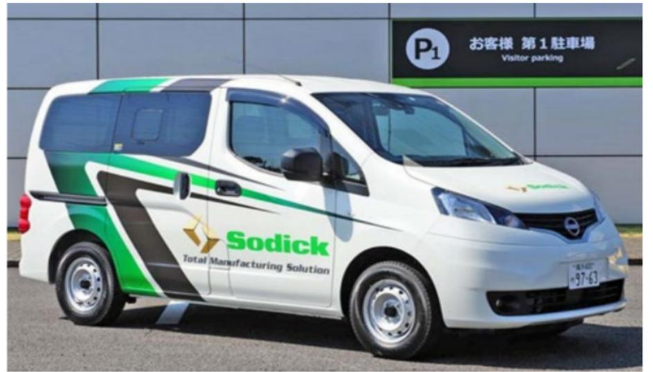
い荷物の積込・積出時の負担を軽減する低床設計を採用したほか、また、放電加工機、MC、射出成形機、食品機械の部品や工具、検査機器など、大小さまざまな荷物に対応できる「可変性荷室」を設置した。さらに荷室は3段に仕切られ、各段の棚板を2分割することもできる仕様で、寸法の異なる荷物の積載がスムーズにできる。
