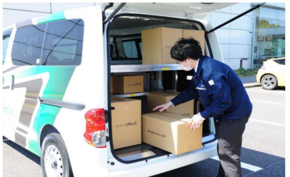
さまざまなサイズに対応できる可変性荷室。低床設計により重い荷物の積込時の負担を軽減。
