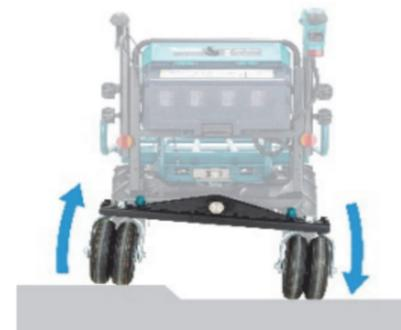
面の凹凸があるところでも、左右の前輪を安定して接地させて駆動することができる。
