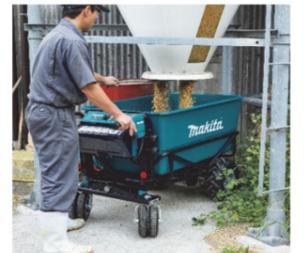
穏やかに減速・停止する。これにより作業も安心して荷物を運搬することができる。走行中はレバークレーキで速度を減速させることができるほか、また、車速0km時には電磁的なサポートブレーキで強力なロックをかけることができ、使い勝手をさらに向上している。
