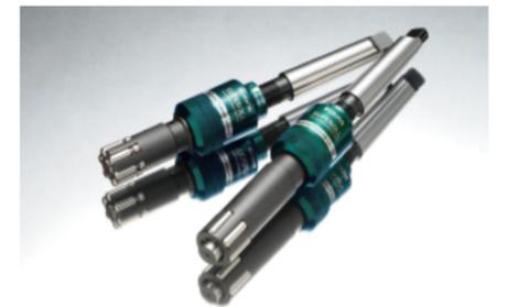
ル」は、ローラで金属表面を押し均して、なめらかに仕上げる鏡面仕上げ工具。ローラによる転圧加工により、金属表面を塑性変形させ加工面をなめらかに仕上げるができる。
