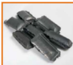
HBI(直接還元鉄) (Hot Briquetted Iron) 天然ガスを改質した還元ガス(水素リッチ)で、直接還元した鉄源
