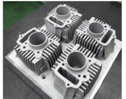
3Dプリンタ「LPM325」の複合加工機能により基準面加工などの2次工程の時間短縮。
