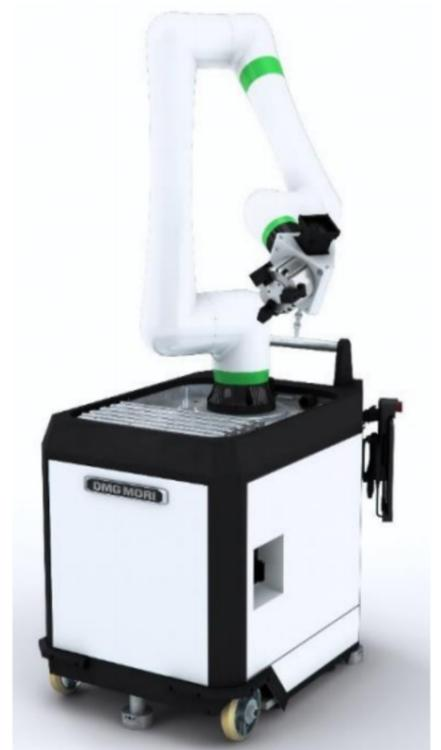
洗浄装置などさまざまな周辺装置との接続が可能。ダイレクトティーチ機能により、ロボット操作の専門知識がなくても容易にティーチングが行える。
