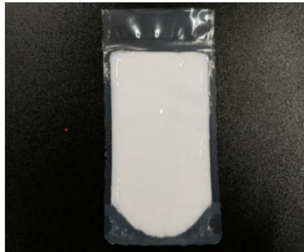
の最高製造濃度は概ね10wt%だったが、NEDOの助成を受けて研究開発を進めることで、15wt%での製造に成功した。濃縮工程を行わない機械解繊CNF水分散液としては、世界最高濃度を達成した（同社調べ）。
