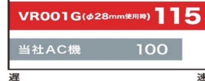
が行え、作業スピードが同社AC機に比べ約15%アップした。φ32mm太径シャフトにも対応し、深基礎や広範囲の作業に適している。
