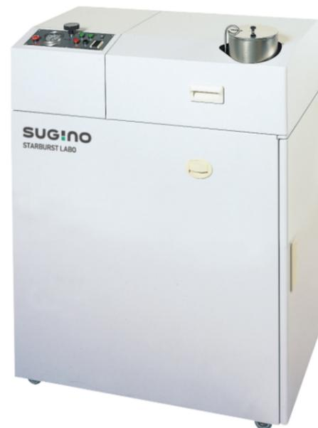
原料同士を超高速(マッハ4の相対速度)で衝突させることで、微粒化(分散・乳化・粉碎・へき開等)を行う、湿式微粒化装置。粉碎媒体を使用しないクリーンな工法として、電子部品材料、電池材料、半導体、顔料・塗料、医薬・化粧品原料など、幅広い用途で導入されている。
