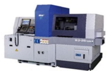
旋盤”とも呼ばれ、直径に比べて部品長が長い部品を高精度に切削できる点が大きき特徴とされている。一般的には、細長い部品を汎用旋盤で加工を行うと、加工物がたわみを起こして正しい寸法に仕上げることができないが、スイス型自動旋盤では、材料の振れ止め装置の働きをするガイドブッシュを用い、刃物はガイドブッシュから一定距離の位置で、外径方向の切り込み運動のみを与えるため、加工物はたわみを起こさずに、高精度に切削できる。
