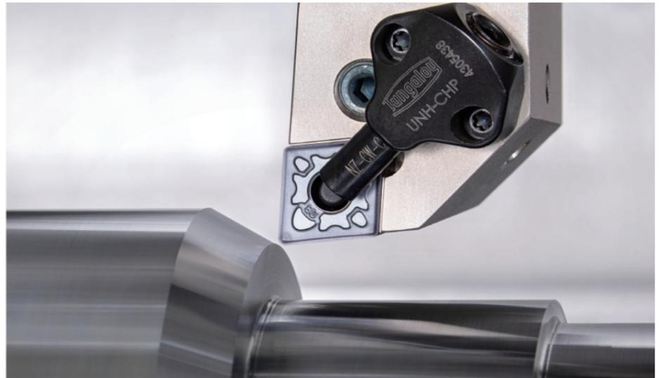
損傷が発生・進行する可能性があるが、新たに追加した「SDM形チップブレード」は、SDM形とAH8000シリーズとの組み合わせにより、被削材の加工でも大幅な寿命延長が期待できる。
