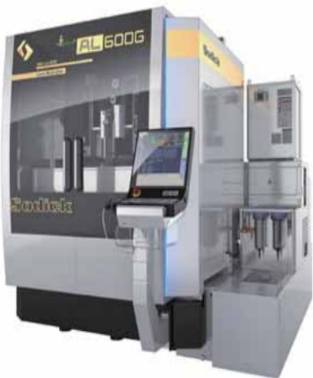
リニアモータ駆動 高速・高性能ワイヤ放電加工機 「AL600G “iGroove+ Edition”」
