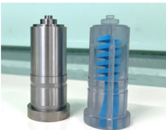
P-Bas®での製作例：金型部品(複雑形状の水管を含有するダイカスト金型用コアピン)
