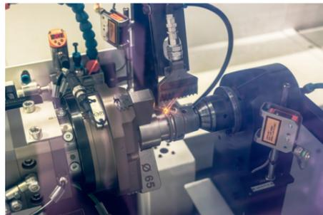
だ。同システムは環境に有害な塩浴硬化に代わるものであり、同システムを用いることで必要なエネルギーを大幅に削減する。
