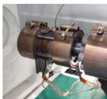
成形機の射出ノズルを外して「Nendy-E」に交換するだけ
