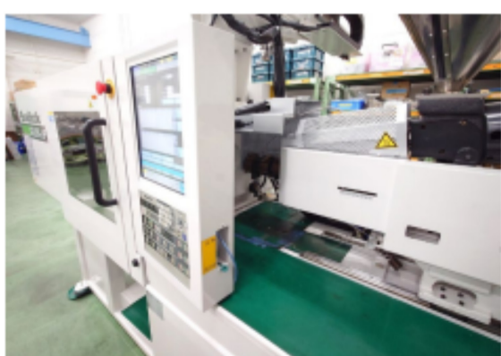
成形機の射出ノズルを外して「Nendy-E」に交換するだけ
