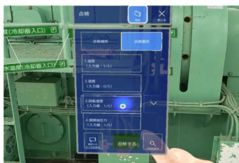
HoloLens 2装着時のイメージ(点検箇所を選択する様子)
