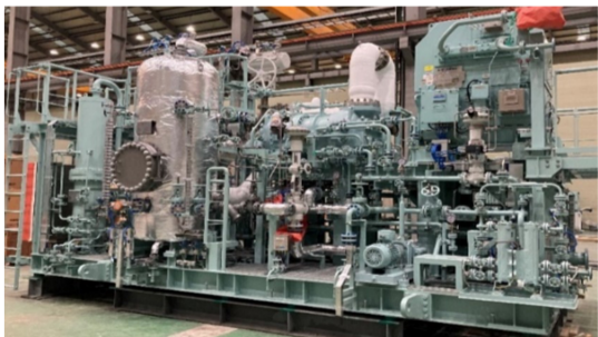
写真上左・LNG船用スクリュウ圧縮機、写真上右・LNG船用レシプロ圧縮機
